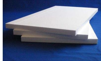
La placa es una pieza cortada para aligerar losas, hacer juntas constructivas, así como aislamiento térmico y acústico, plafones o cimbras muertas, generalmente en forma de prisma rectangular. Si la pieza mide en uno de sus lados 10 cm o menos se le denomina de esta manera.
